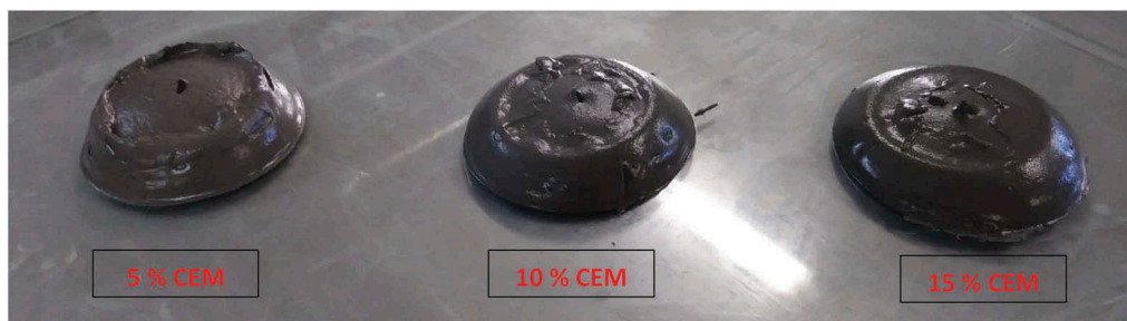
Figure 4. Uzyskane kształty placków rozplýwowych mieszanin popiółowo-cementowych. Source: own study.
